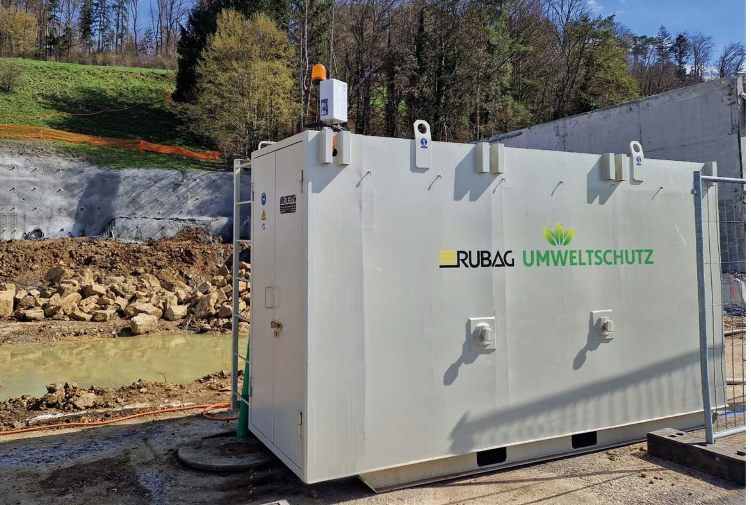
*Stabilisation de pente et excavation: bassin de 10 m<sup>3</sup> de notre parc de location en service à Bubendorf BL sur le chantier de la société Alter Aushub & Abbruch*
