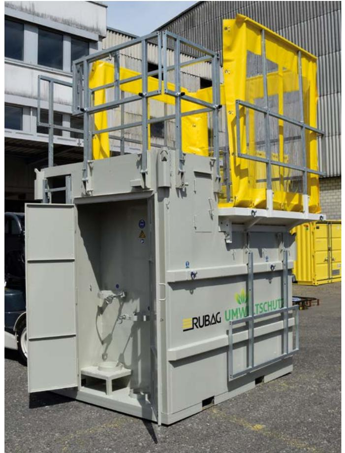
*L'armoire technique est spacieuse et offre suffisamment de place pour les bouteilles de gaz et l'installation de neutralisation. Photo avec rehausse de surface de lavage XL et protection contre les projections.*
